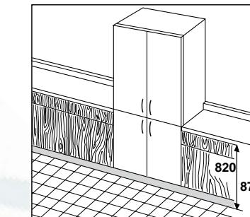
Перед тем, как установить холодильник между мебелью, отрегулируйте высоту задних колес и ножек. Колеса устанавливаются на заводе на высоту 820 мм. Чтобы поднять прибор до высоты 870 мм необходимо вращать специальным ключом ножки, затем отсоединить колеса и закрепить их в самом нижнем положении.
